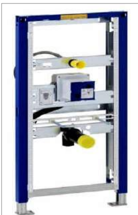
Duofix Urinal-UP-Element. Für die Montage vor eine tragende Wand. H = 112 B = 50 T = var. Zur Aufnahme einer HyTronic Urinalsteuerung.
