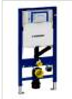
Duofix Spülkastenelement mit Geruchabsaugung. H = 112 B = 50 T = variabel. Mit Spülkasten Typ UP320, für alle Betätigungen der Sigma-Reihe.
