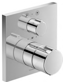
Thermostatischer Wannenmischer „C1“ von Duravit. Wanneneinlauf über den Wannenüberlauf. Eckiges Design. Mit Verbrühschutz.
