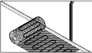
In der Nähe der Anschlussdose mit dem Verlegen der Heizmatte beginnen. Die Heizmatte mit dem Heizleiter nach unten ausrollen und dem Grundriss anpassen. **Die Heizmatte ist selbstklebend!**
