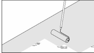
Als Haftbrücke die zum Fliesenkleber empfohlene Grundierung nach Herstellerangaben auf den vorhandenen Untergrund aufbringen.
