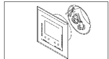
Den Temperaturregler anschliessen. Die erstmalige Inbetriebnahme der Elektro-Flächenheizung darf frühestens 48 Stunden nach dem Verlegen des Oberbodenbelags erfolgen. Bitte dabei die Angaben des Kleberherstellers beachten. Während der ersten 24 Stunden der Inbetriebnahme darf die Bodentemperatur 25 °C nicht überschreiten.
