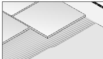
Den Fliesenkleber oder die Spachtelmasse trocknen lassen. Danach mit dem Verlegen des Deckbelags beginnen. Keramische Beläge mit flexiblem Fliesenkleber und Zahnpachtel verlegen. Bei anderen Oberbodenbelägen wie z. B. Laminat, Teppich, PVC den Heizleiter mindestens 5 mm mit Fliesenkleber bzw. Fließmörtel überdecken.
