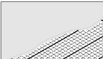
Die Heizmatte mit Fließmörtel oder Fliesenkleber einspachteln und sicherstellen, dass der Heizleiter vollständig mit Fliesenkleber oder mit Fließmörtel umschlossen wird.
