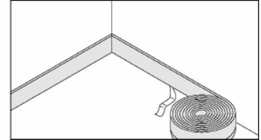
Den Randdämmstreifen entlang der Wände, Säulen oder Treppen auf dem vorbereiteten Boden fixieren.
