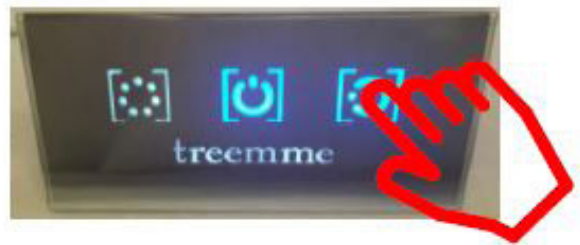
Funzionamento automatico. Variazione continua dei colori (16/17 sec. per colore) Automatic mode. Continuous variation of colors (16/17 sec. per color)
